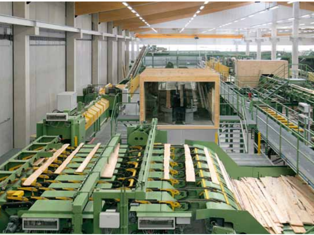
Die Bedienung der gesamten OptiDrive Line erfolgt in der Bedienkabine geschützt vor Staub und Lärm
