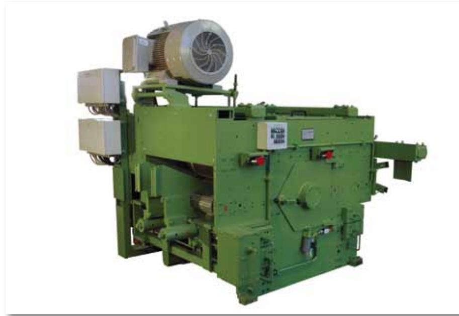
DK 90, Auszugsseite mit hydraulisch positionierbaren Spaltkeilen
